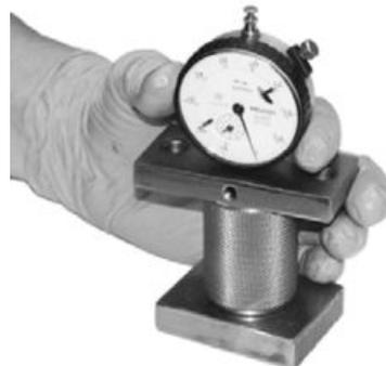
Ruotare manualmente la camma di iniezione fino a identificare il raggio di base della camma e memorizzare se vi è differenza in positivo o in negativo rispetto alla quota di 53,2 mm.
