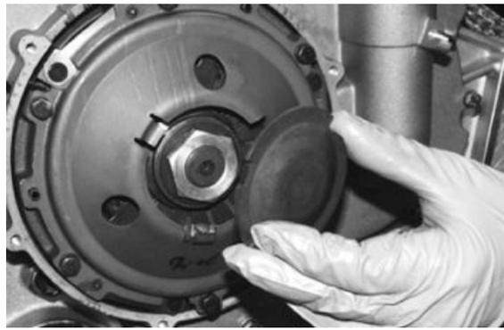
Posizionare l'attrezzo specifico di arresto frizione e svitare il dado di serraggio.
