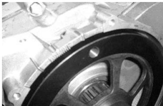
Utilizzando il volano fare ruotare l'albero motore di due o tre giri per permettere alla cinghia di distribuzione di assestarsi.
