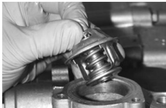
Controllare ed eventualmente sostituire l'anello di tenuta. Serrare i tre bulloni di fissaggio alla coppia prescritta.
