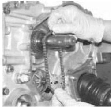
Svitare i due bulloni che fissano la pompa olio ed estrarla ponendo attenzione al corretto senso per il rimontaggio.
