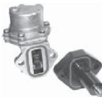
Verificare sempre ed eventualmente sostituire i due O-Ring di tenuta
