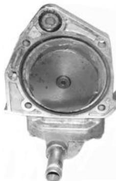
In caso di malfunzionamento la pompa acqua non è riparabile, si può solo sostituire.
