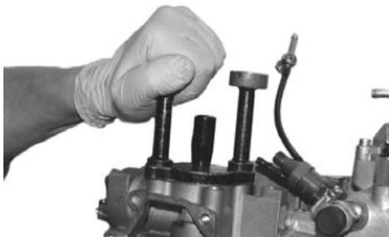
Rimontare sulla camma di iniezione le masse del variatore di anticipo, avvitarle la vite di fissaggio manualmente senza serrarla completamente. Inserire l'attrezzo specifico per fasare correttamente le masse del variatore di anticipo con la camma di iniezione.
