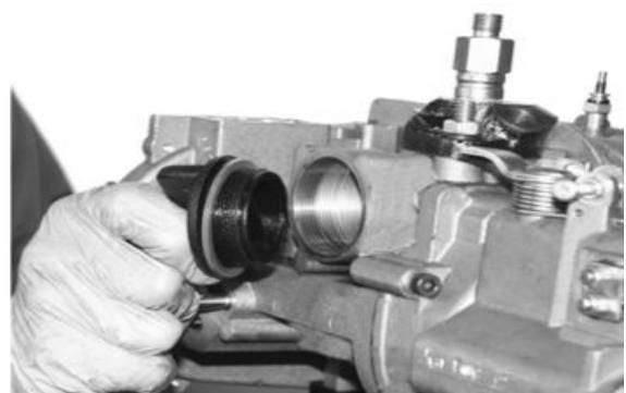
Serrare i dadi di fissaggio della pompa di iniezione al supporto con chiave dinamometrica alla coppia prescritta.
