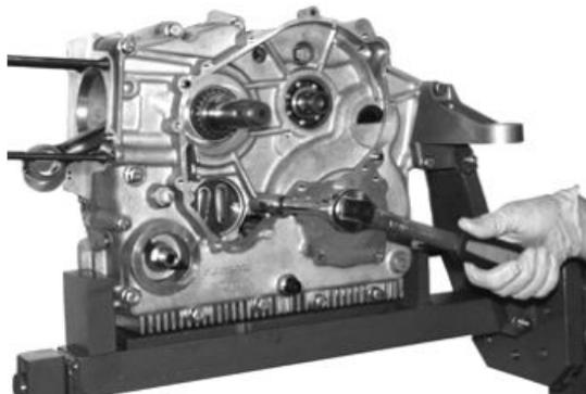
posizionare il motore orizzontalmente come rappresentato in figura e mediante colpi di mazzuolo in gomma separare i due semicarter.
