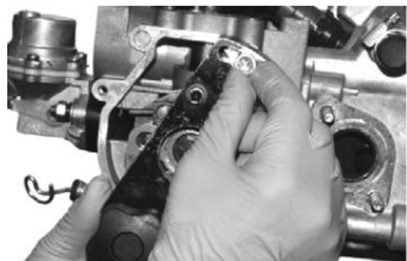
Ruotare l'attrezzo specifico in senso antiorario, esso faserà il variatore di anticipo in posizione corretta con la camma di iniezione perfettamente a contatto con la punteria di iniezione.
