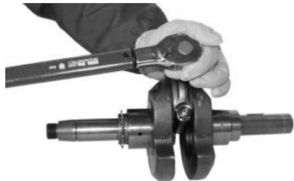
**LA SOSTITUZIONE DEI SEMICUSCINETTI DELLA TESTA DI BIELLA E' AMMISSIBILE SOLO SE L'ALBERO MOTORE E' PRIVO DI RIGATURE, ABRASIONI OD OVALIZZAZIONE.**
