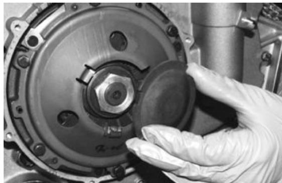
Posizionare l'attrezzo specifico di arresto frizione e svitare il dado di serraggio.
