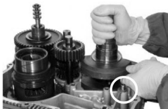
prestare attenzione che il **raccordo (N)** e l'anello **o-ring (I)** siano integri e posizionati correttamente.
