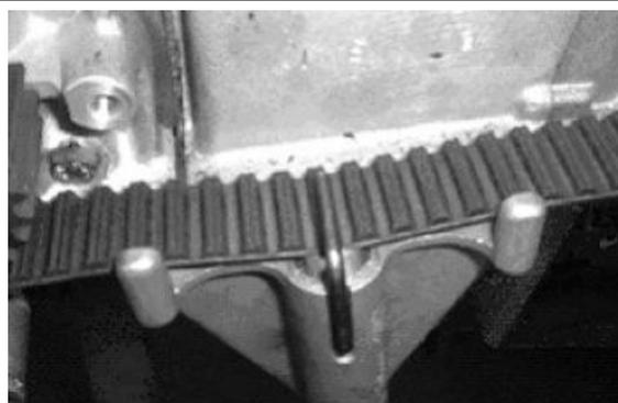
Per essere corretta la tensione deve risultare compresa fra i 25 e i 28 KgSè così non fosse, allentare il tendicinghia e a secondo del valore letto, aumentare o diminuire il tensionamento. Riserrare il dado di fissaggio del tendicinghia alla coppia prescritta, fare ruotare l'albero motore di due o tre giri e riverificare con lo strumento la tensione della cinghia
