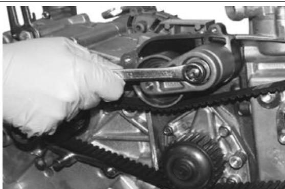
Agendo in questo modo si scarica la cinghia dentata della distribuzione dalla pressione di tensionamento e ne permette la rimozione.
