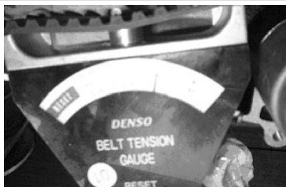
Raggiunto il tensionamento corretto della cinghia dentata di distribuzione rimuovere dall'albero a gomito l'attrezzo per la messa in fase, utilizzando un estrattore universale e quindi rimontare la frizione
