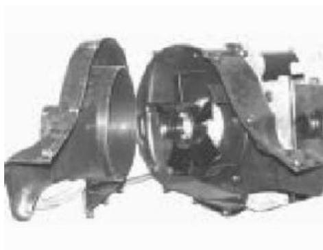
Montare infine il convogliatore del radiatore e fissarlo con le nove viti (sei di M 6x20 e tre di M 6x25) fissarle quindi alla coppia prescritta.
