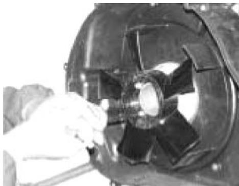
Verificare l'integrità di tutte le pale, anche se una sola risulta danneggiata è necessario sostituire la ventola
