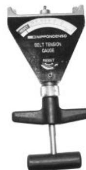
Al fine di ottenere una lettura del valore di tensionamento corretto, dovremo porre il sensore dello strumento sul dente della cinghia
