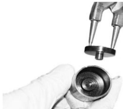
Nel bullone raccordo di adduzione combustibile proveniente dal filtro gasolio alla pompa di iniezione vi è alloggiata la valvola per facilitare l'arresto del motore. Essa è composta: da una molla, una sfera metallica, mentre la sede di tenuta della sfera è ricavata all'interno del bullone raccordo
