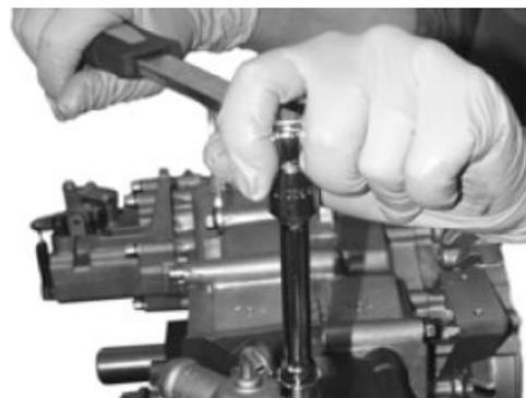
Controllare ed eventualmente sostituire l'O-Ring di tenuta al fine di evitare aspirazioni d'aria.
