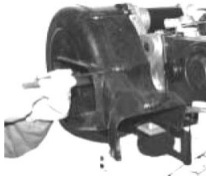
Per le 3 viti nella parte inferiore si deve utilizzare un giravite tipo cortissimo con impronta a croce
